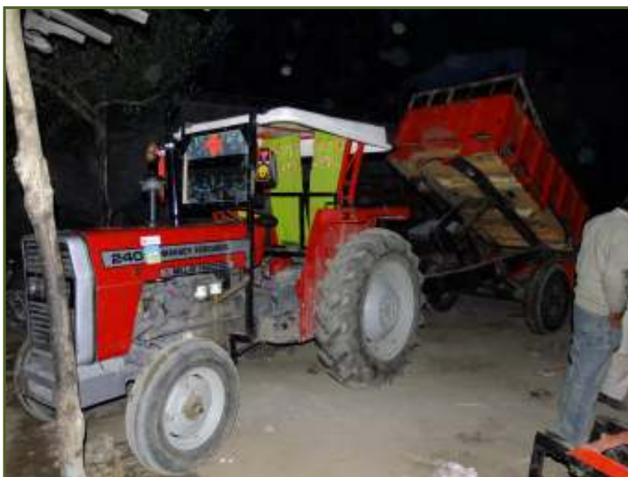
Nový traktor s vlečkou doplněný střechou, sedačkou a bednou
